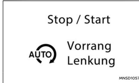
Dieser Hinweis wird beim Anhalten des Fahrzeugs angezeigt, wenn das Stopp-Start-System deaktiviert ist, weil eine Lenkungsbetätigung erkannt wird.
