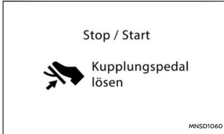
Dieser Hinweis wird beim Anhalten des Fahrzeugs angezeigt, wenn das Stopp-Start-System deaktiviert ist, weil das Kupplungspedal nicht vollständig losgelassen wurde.
