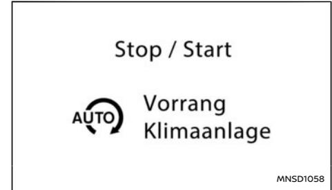
Dieser Hinweis wird beim Anhalten des Fahrzeugs angezeigt, wenn das Stopp-Start-System deaktiviert ist, weil der Klimaanlage (Kühl-, Heiz- oder Beschlagentfernungsfunktionen) Vorrang gegeben wird.
