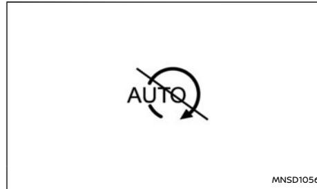
Diese Anzeige erscheint beim Anhalten des Fahrzeugs, wenn der Motor aufgrund von Sperrungsbedingungen nicht automatisch durch das Stopp-Start-System gestoppt werden kann.
