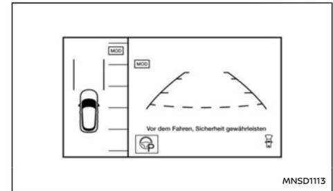
Das System führt den Fahrer mittels Sprachführung Schritt für Schritt in die Parklücke.
