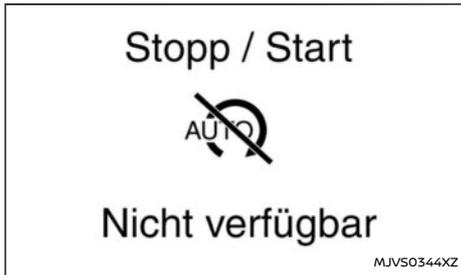
Falls der Motor stoppt, wenn das Stopp-Start-System aktiviert ist, und sich nicht automatisch starten lässt, wird diese Nachricht angezeigt.
