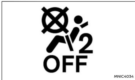
1. Wenn das Kinderrückhaltesystem auf dem Beifahrersitz befestigt ist, schalten Sie die Zündung ein. Die Anzeige <PASSENGER AIR BAG OFF>
