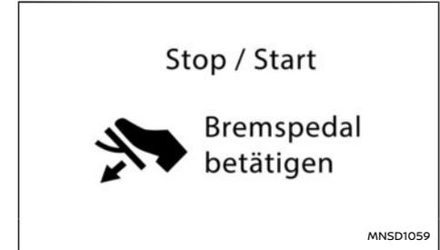
Dieser Hinweis wird beim Anhalten des Fahrzeugs angezeigt, wenn das Stopp-Start-System deaktiviert ist, weil das Bremspedal nicht vollständig betätigt wurde.
