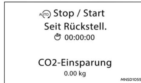
Während der Motor abgestellt ist, kann die Fahrzeuginformationsanzeige die geschätzte Menge an Kohlendioxid anzeigen, deren Ausstoß (falls vorhanden) durch das Stopp-Start-System verhindert wurde.
