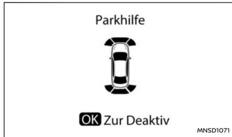
Wenn sich das Fahrzeug in R (Rückwärtsgang) befindet und der Bildschirm [Parkhilfe] in der Fahrzeuginformationsanzeige angezeigt wird, kann das RAB-System durch Drücken des Schalters <OK> am Lenkrad vorübergehend deaktiviert werden.
